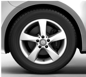
43,2 cm (17") Leichtmetallräder im 5-Speichen-Design, vanadiumsilber lackiert, mit Bereifung 225/55 R17 (Serie Avantgarde) (RL8)
