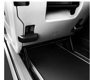
Sitzschienensystem mit Schnellverriegelung zum Ein- und Ausbau der Fondsitze
