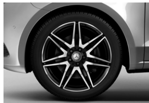
48,3 cm (19") AMG Leichtmetallräder im 7-Doppelspeichen-Design, schwarz lackiert und glanzgedreht mit Bereifung 245/45 R19 (RK4)
