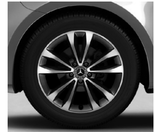
45,7 cm (18") Leichtmetallräder, 5-Doppelspeichen-Design, glanzgedreht, mit Bereifung 245/45 R 18 (R1O)
