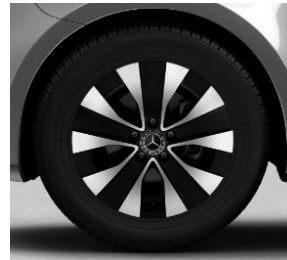
43,2 cm (17") Leichtmetallräder, 5-Doppelspeichen-Design, schwarz, glanzgedreht, mit Bereifung 225/55 R 17 (R1N)
