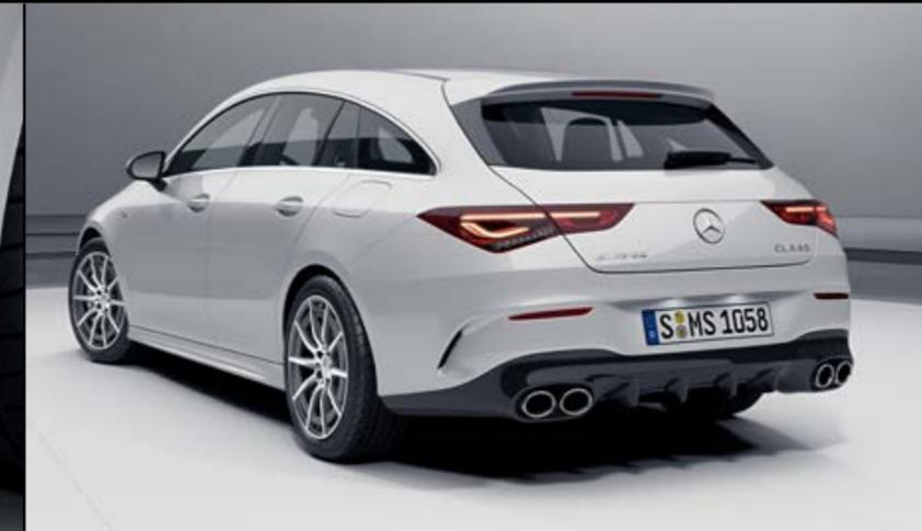
AMG Abgasanlage mit zwei runden Doppelendrohrblenden mit je 82 mm Durchmesser
