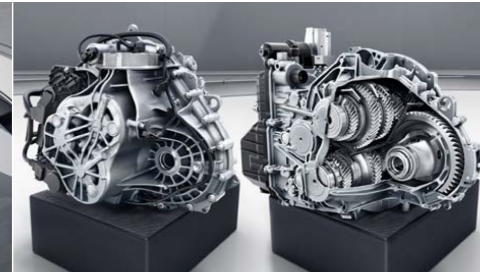
7G-DCT oder 8G-DCT Doppelkupplungsgetriebe, das sich aus zwei Teilgetrieben zusammensetzt
