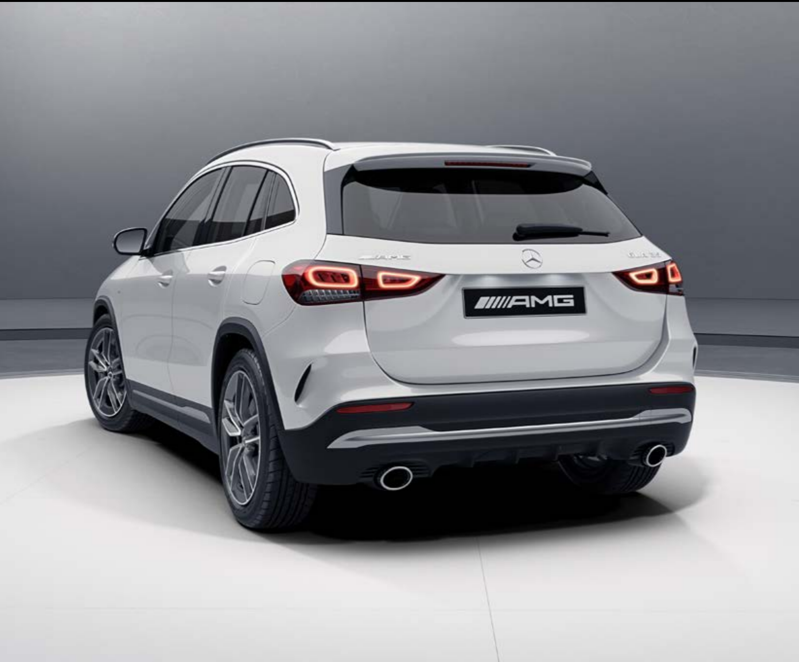
Der Mercedes-AMG GLA 35 4MATIC besitzt eine AMG Abgasanlage mit zwei runden Doppelendrohrblenden mit je 90 mm Durchmesser.
