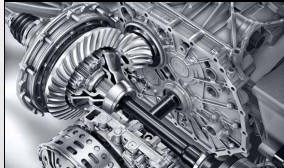
467 – AMG elektronisches Sperrdifferenzial Hinterachse
