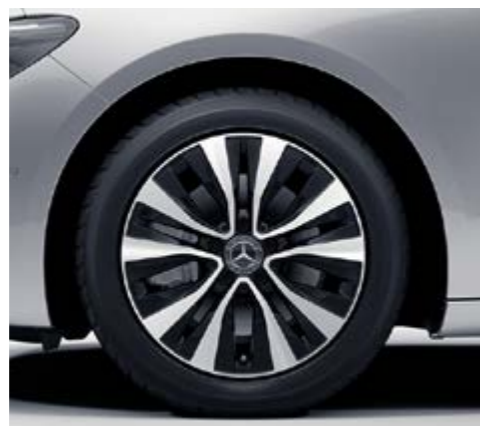
R04 – 17"-Leichtmetallräder im 5-Doppelspeichen-Design, serienmäßig bei Style Line (PYD) (EUR —,—) mit 205/55 R 17 auf 6,5 J x 17
